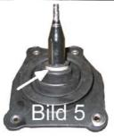
Jetzt wird das Kunststofflager auf der kleinen Kugel abgedrückt und auf dem Short-Shifter montiert. Die Kunststofführung in der großen Kugel wird mit einem kleinen Schraubenzieher herausgehebelt und in die Ausfräsung des Short-Shifters gedrückt. (siehe Bild 6 und 7)
