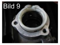
Legen Sie die Papierdichtung auf die Dichtfläche und stecken Sie den Distanzflansch auf. Der Stift ist so zu justieren, dass er über dem originalen Stift und in der Aussparung des unteren Kunststofflagers sitzt. (siehe Bild 11)
