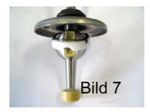
Legen Sie nun das weiße Kunststofflager mit Federring auf die Short-Shifter Kugel und Schieben Sie die neue Dichtmanschette auf. (siehe Bild 7).
