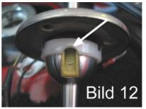
Stecken Sie den Short-Shifter jetzt senkrecht in das Getriebe. Dabei muß die Kunststofführung über den Stift gebracht werden. Befestigen Sie die Dichtmanschette mit den mitgelieferten Schrauben.
