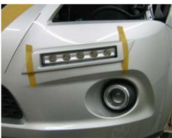
Fixieren Sie nun für die nächsten 12 Stunden das Gehäuse mit Klebeband.
