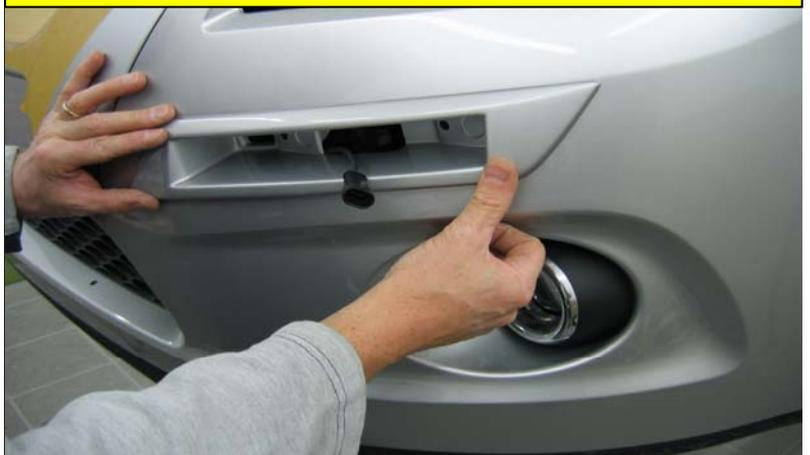
Reinigen Sie nun die Klebekontaktfläche um den Ausschnitt gut mit Siliconentferner.
