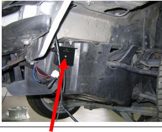
Die Vorschaltgeräte montieren Sie links an dieser Position
