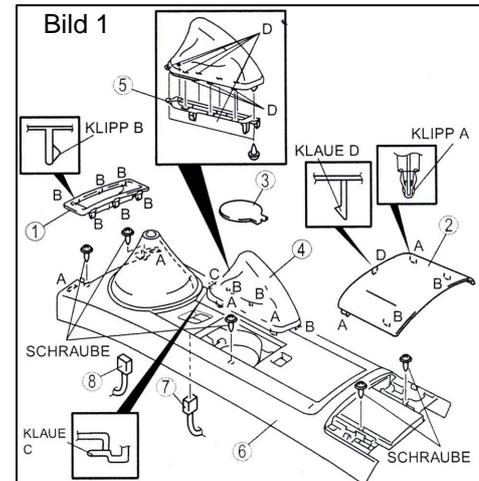
Drehen Sie die Konsole um und entfernen durch Lösen der Schrauben das Dosenfach mit Schiebedeckel.
