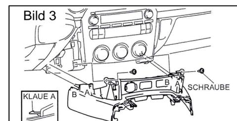
Jetzt werden Konsolenblende, Seitenblende und Mittelkonsole in umgekehrter Reihenfolge wieder eingebaut.
