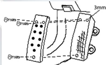
Die Gaspedalplatte wird auf das Gaspedal gelegt und die Befestigungslöcher markiert. Mit einem 4 – 4,5 mm Bohrer bohren Sie an den markierten Positionen. Mit den im Lieferumfang enthaltenen Schrauben wird die Gaspedalplatte befestigt.
