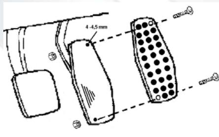
Die Kupplungs- und Bremspedalabdeckung montieren Sie wie folgt. Schieben Sie die Abdeckung von unten über die Pedalplatte. mit einem kleinen Schraubendreher hebeln Sie den Gummi über die Pedalplatte.
