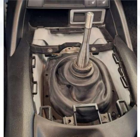
2. Demontieren Sie die Mittelkonsole in dem Sie die beiden Schrauben lösen (Bild 6) und die Mittelkonsole aus den Halteclips ziehen.(Bild 7) Lösen Sie die Steckverbindung unter der Mittelkonsole.(Bild 8)
